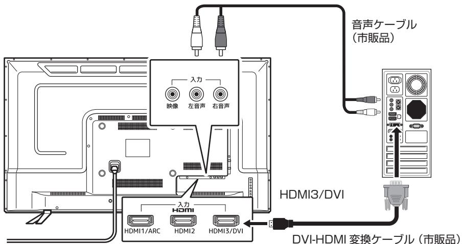
パソコンの音声を本機のスピーカーで聞く場合は、HDMI3/DVI入力端子と接続し、メニューのビデオ音声入力設定をHDMI3 アナログ音声に切り替えます。(54 ページの「ビデオ音声入力設定」を参照してください。)
