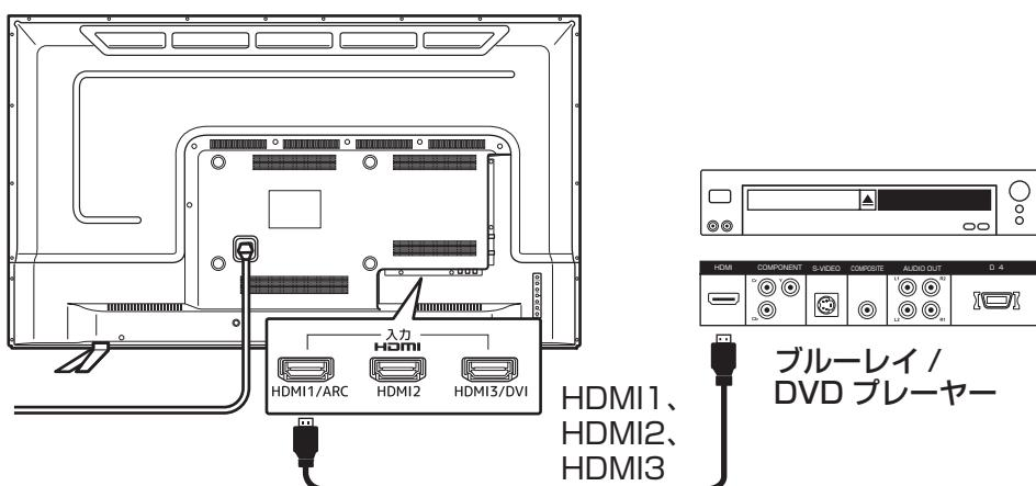
また本機のHDMI1/ARC入力端子はHDMI ARC（オーディオリターンチャンネル）に対応しています。
